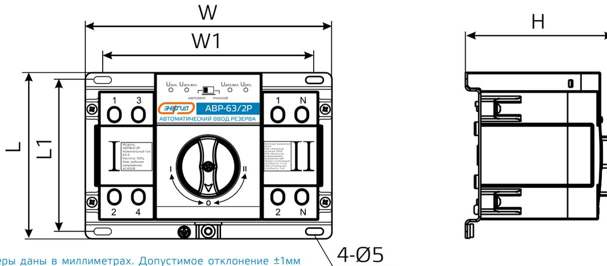
\*Размеры даны в миллиметрах. Допустимое отклонение  $\pm 1\text{мм}$
